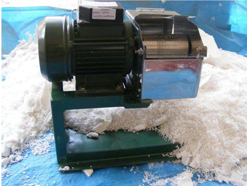
Gb. 27. Mesin Parut Kelapa Alih Fungsi Parut Styrofoam
