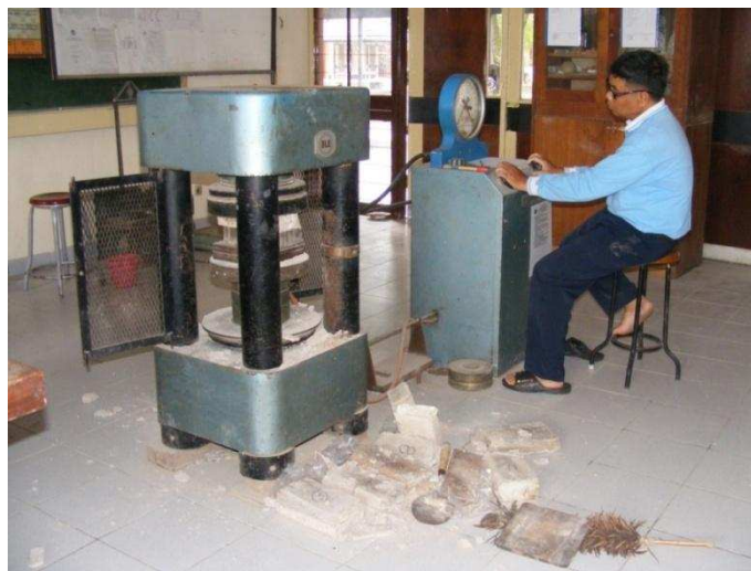
Gb. 24. Pengukuran dalam Uji Kekuatan Tekan
