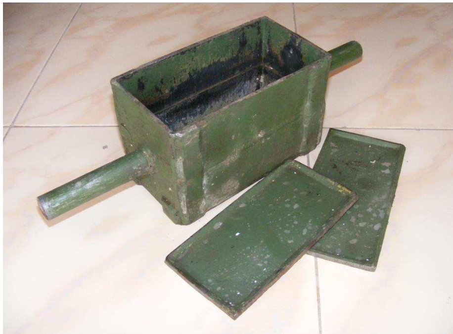
Gb. 6. Tempat Adonan pada Cetakan Hidrolik (Cetak Tekan)
