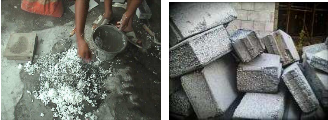
Gb. 8 dan 9. Pembuatan Batako Bahan Baku Styrofoam dan Pasir Kasar dengan Perekat Semen
