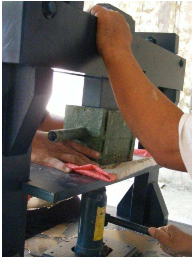
Gb. 19. Proses Pencetakan Media Dengan Cara di Press
